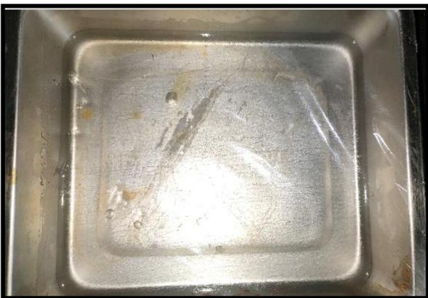
圖十一 加入 1 M  $\text{NaHCO}_3$ ，浸泡 1 天，降低鹼性
