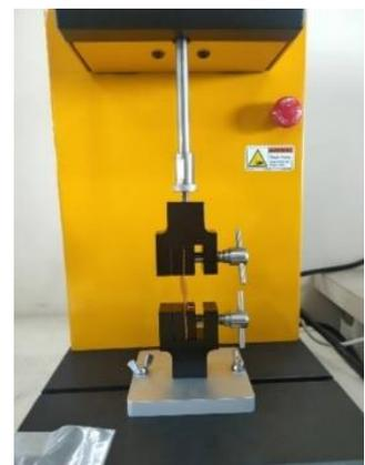
圖三 質構分析儀 (測拉力儀)
