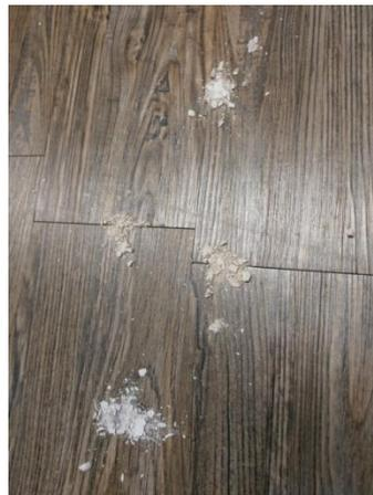
圖 15：抗壓性測試－成品碎裂
