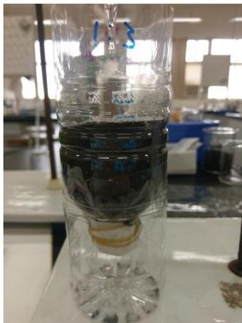
圖 10：透水性測試
