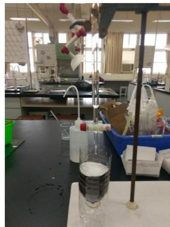
圖 11：透水性測試
