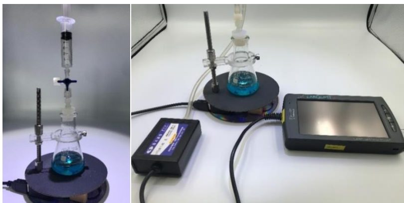
圖 4：氣壓偵測裝置圖
