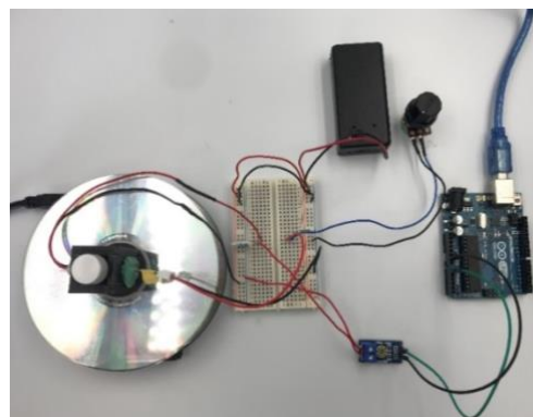
圖 2：可程式光電比色電壓感測暨攪拌模組組件圖(未貼水砂紙)
