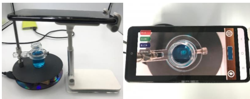
圖 6：色碼分析裝置，樣本瓶放置在貼上水砂紙的電磁攪拌器上
