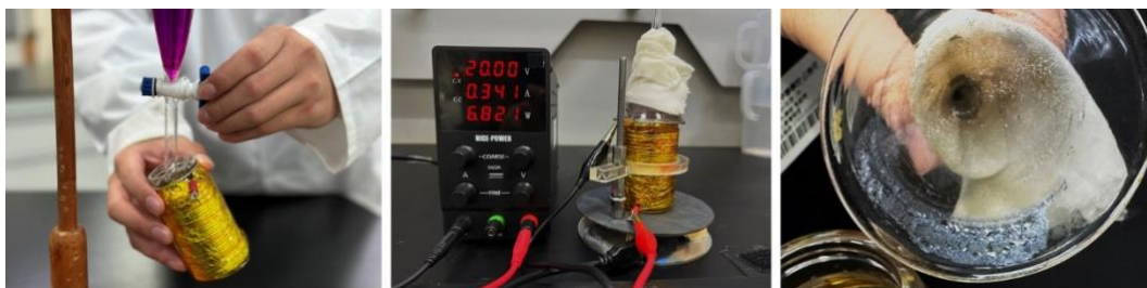
圖 37：圖中為電熱式裝置，圖右為漏斗上析出的碘晶體
