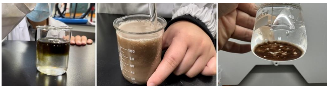
圖 38：圖左加入 Na_2S_2O_3 、圖中加入 Na_2CO_3 、圖右為沉澱的錳氧化物
