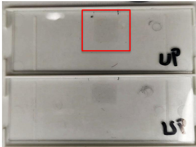
圖十五、Graphene/Ag-doped 異質結構材料之透明度實際測量樣品 (紅框內之半透明正方形為轉印至玻片上的材料)
