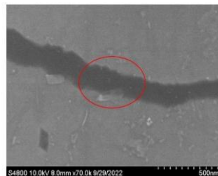
圖十、Graphene/Ag-doped 異質結構於高倍率電子顯微鏡下之影像 (紅圈表示析出之銀線)
